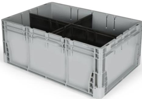
Conçus selon la norme FM Global (Factory Mutual Global), les **Bacs AE** présentent un fond renforcé à double paroi de type "sandwich", pour une résistance et une durabilité accrues. Cette conception innovante permet non seulement de réduire le bruit sur les convoyeurs, mais également de renforcer la capacité de charge, avec une moyenne de 35 à 40 kg par bac.
